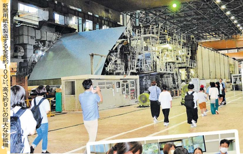
新聞用紙を製造する全長約100m、高さ約9mの巨大な抄紙機
