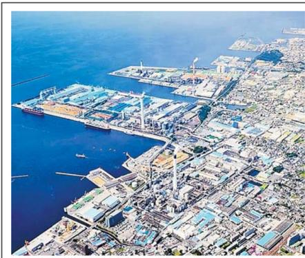
大王製紙三島工場 愛媛県四国中央市に位置。敷地面積約167万平方mの臨海工場で、工場内に140万世帯を賄える自家発電や浄水施設、古紙倉庫がある。港に隣接しており、国内外から船で運ばれたチップが工場内に運搬しやすい構造。年間200万tの紙・板紙を生産する能力がある。日本海新聞の用紙の一部を生産している。
